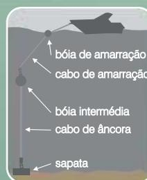
**1** Instalação de amarrações para embarcações de recreio, fixas com um sistema de cabos e destorcedores, com uma bóia à superfície e outra a meio da coluna de água, de modo a evitar o arrastamento dos cabos de amarração no fundo;
